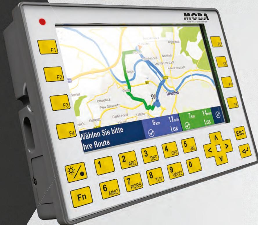
Hitri **MOBA Operand** s štirijedrnim procesorjem prikazuje podatke o naročilu in meritvah neposredno v voznikovi kabini in jih daje na voljo za takojšnjo obdelavo. Zahvaljujoč odprtemu operacijskemu sistemu je vgrajeni računalnik združljiv z vso običajno programsko opremo za upravljanje in ga je mogoče hitro in enostavno vključiti v katero koli namestitev.
