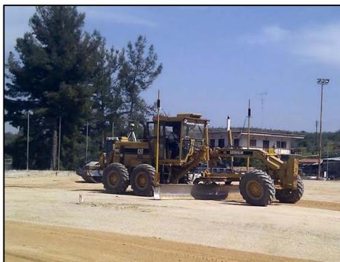
*Innerhalb von nur zwei Stunden konnte der Grader mit dem Nivelliersystem die Fläche nivellieren*
