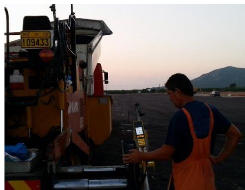
Danke des Nacht-Designs der Bedieneinheit MOBA-matic II ist die Bedienung auch bei Dunkelheit kein Problem
